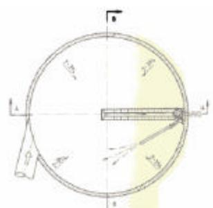
Fig. 8. Limpiador giratorio en un tanque circular
