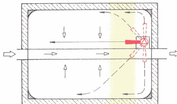
Fig. 6. Limpiador giratorio en un tanque rectangular
