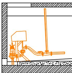
Fig. 4. Diseño dispositivo giratorio con accionamiento sumergido
