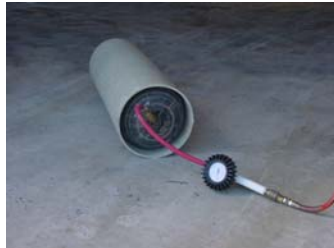
Inflado del Balón obturador (ciego) con el hinchador con manómetro.
