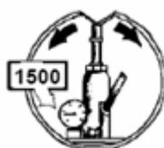
7.- Cuando el centro de la “V” está expandido, se reduce la presión. Deberá seguir bombeando con el gato hasta alcanzar los 2000 psi o 143 bar.
