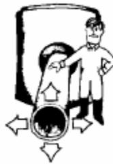
NOTA: El tubo no debe descansar sobre la banda de expansión de la junta.
