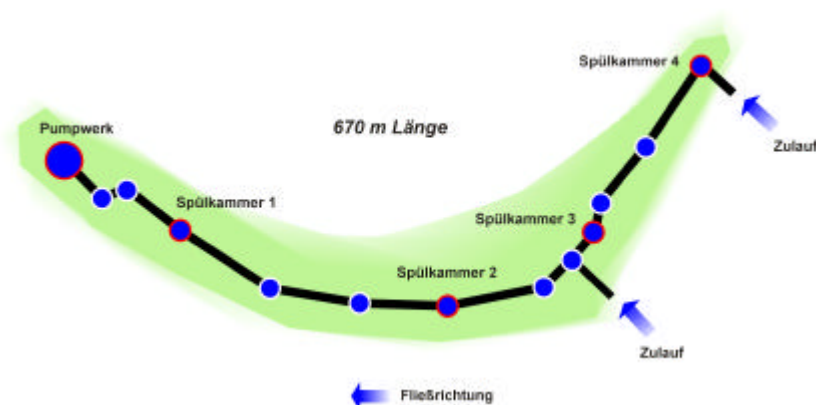
Fig.1 Red de alcantarillado con varios limpiadores por compuertas
