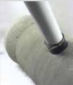
Das Steigelement wird aus einem 12 mm dicken Stab aus Riffelstahl AEH 500 gefertigt und ist mit einer neuen, enorm stoßfesten Polypropylen-Copolymer-Schicht überzogen, um Materialbeschädigungen beim Einbau zu vermeiden.
