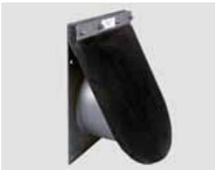
Im Becken sitzen Rückschlagklappen in der gemeinsamen Wand zwischen Zentralkanal und Sammelkammer. Sie sperren den Zugang des Wasser von der Zentralkammer in die Sammelkammer und ermöglichen seinen Fluss in die entgegengesetzte Richtung. So wird verhindert, dass die Sammelkammer sich bei kleineren Regenereignissen füllt und später eine entsprechende Reinigung erforderlich wird.
