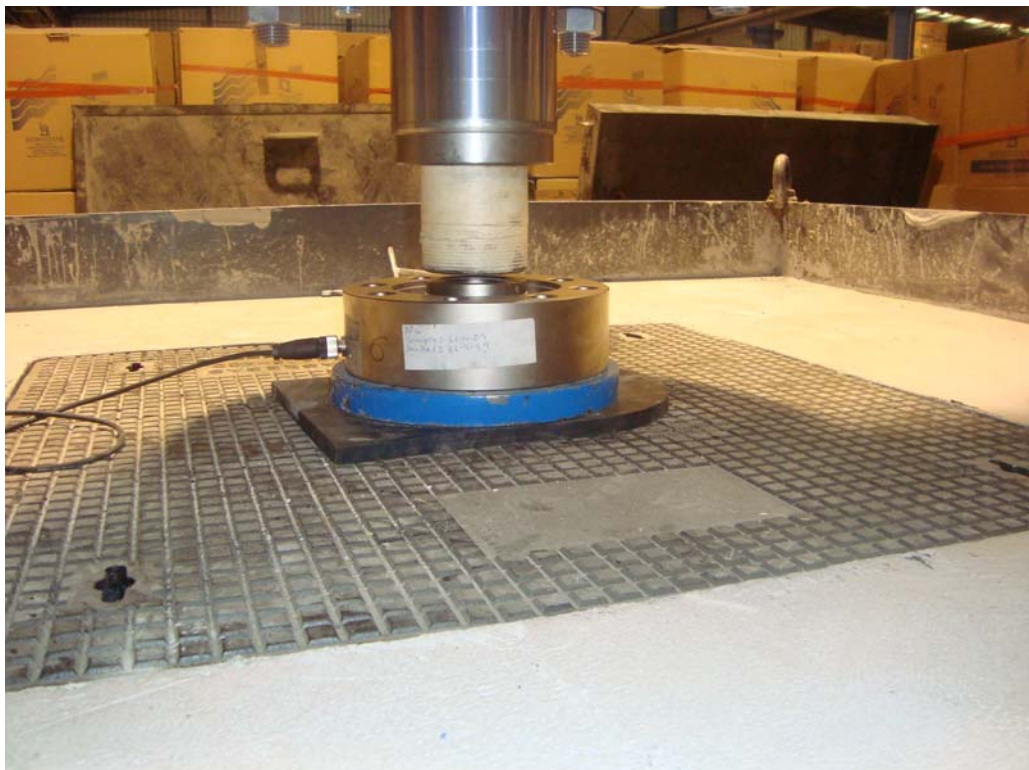
Detalle zona aplicación de la carga y célula de carga
